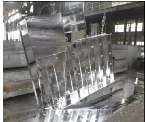
2ト以上の浴橋防止ブラケットの施工
