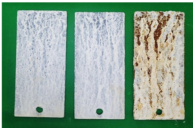
写真 第三者機関での中性塩水噴霧試験 3000 時間経過後の外観
